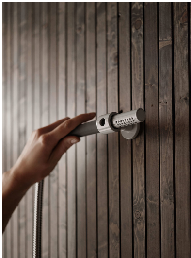
T9 Handdouchehouder om handdouche T2 horizontaal te plaatsen zodat gebruik als hoofddouche mogelijk is, wandmontage. Niet geschikt voor handdouche T60.
